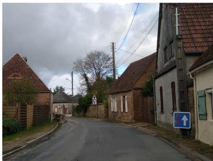
La circulation des PL dans des espaces contraints par le bâti engendre un sentiment d'insécurité. Les trottoirs trop étroits et discontinus ne permettent pas aux piétons de circuler de manière sécurisée. Ils réduisent également la marge de sécurité pour les riverains souhaitant s'insérer sur l'axe RD 17 / RD 12.
